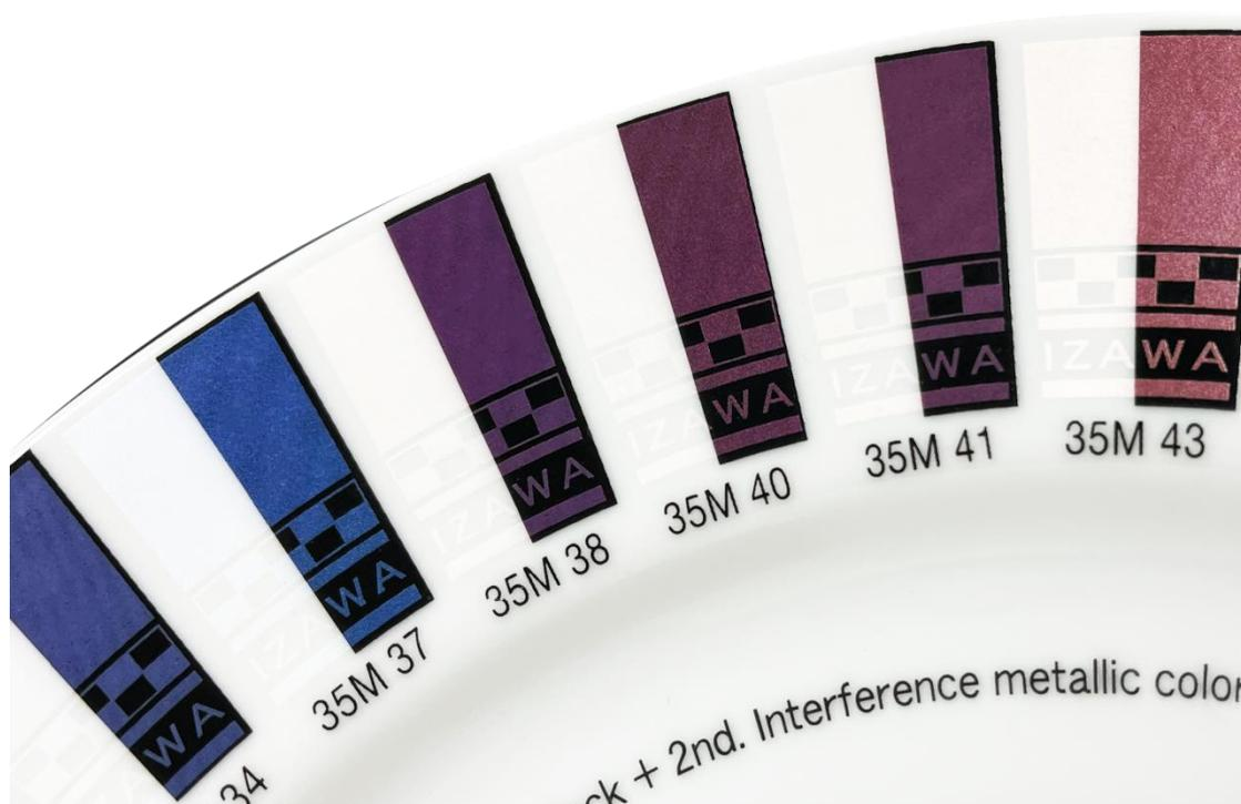
**35M 系列** 800-880°C无铅无镉，釉上仿金和干扰色，可互混。适用于硬质瓷、骨灰瓷、陶器、瓷器及搪瓷。
